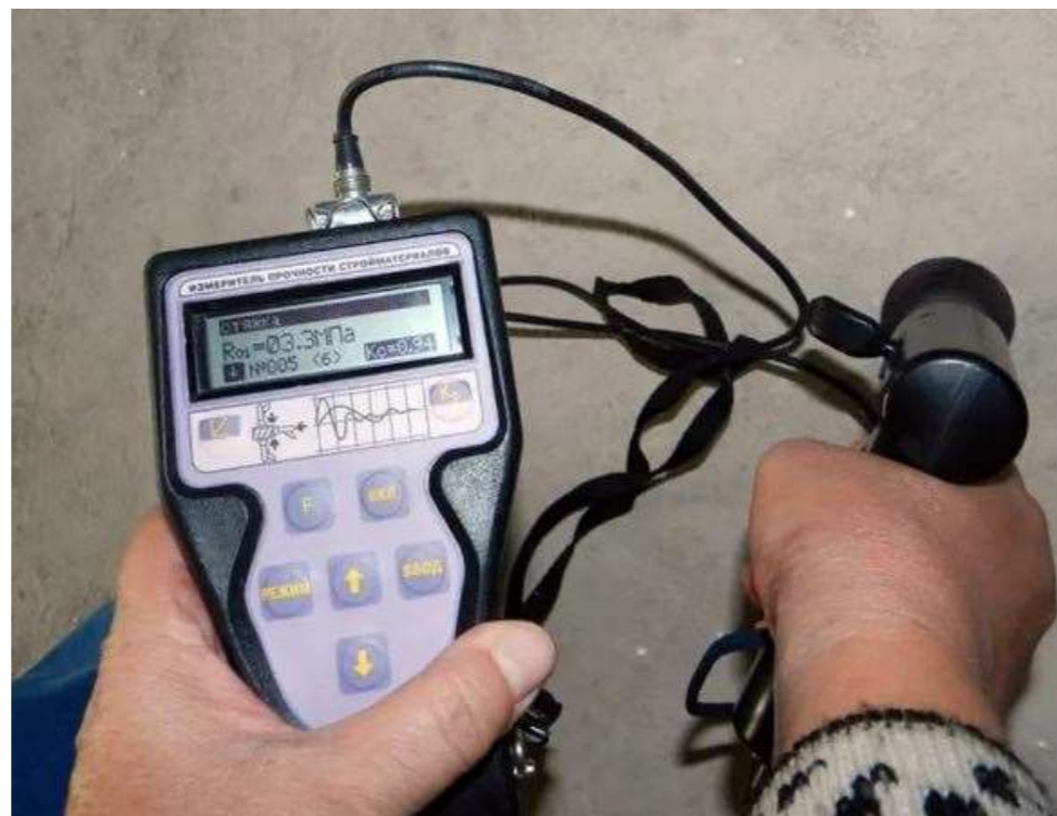
ИЗМЕРЕНИЕ ПРОЧНОСТИ БЕТОННЫХ КОНСТРУКЦИЙ
